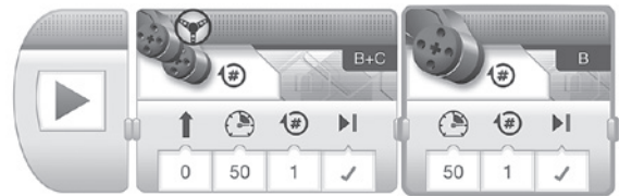
図4 ステアリング+Lモータの命令ブロックの追加
