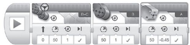
図5 Mモータの命令ブロックの追加 (図2③)
