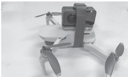
図3 ドローンと360度カメラ合体自作版
